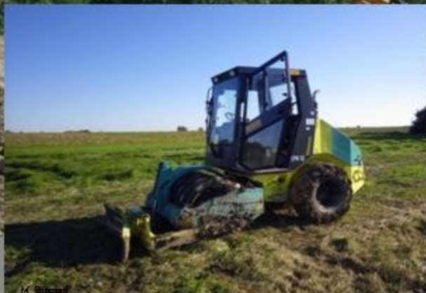
«Pied-de-mouton» pour le tassement de matériaux terreux
