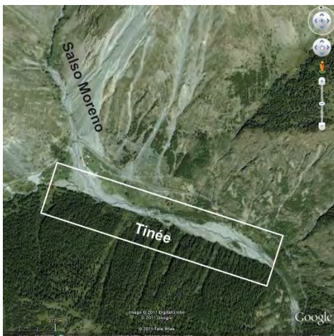
Figure 29 Exemple d'apports sédimentaires secondaires en montagne provenant d'un affluent (Salso Moreno) sur la Tinée (06) (Recking et al., 2013)
